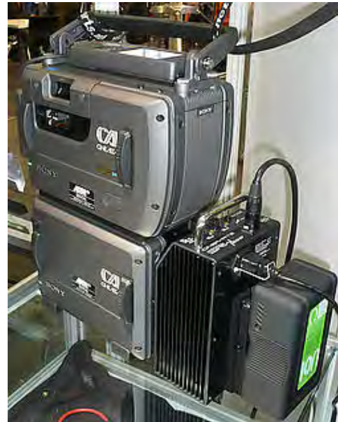
Cineparts zeigte lüfterlose, andockbare, batteriegepufferte Netzteile, unter anderem für den SRW-1.
