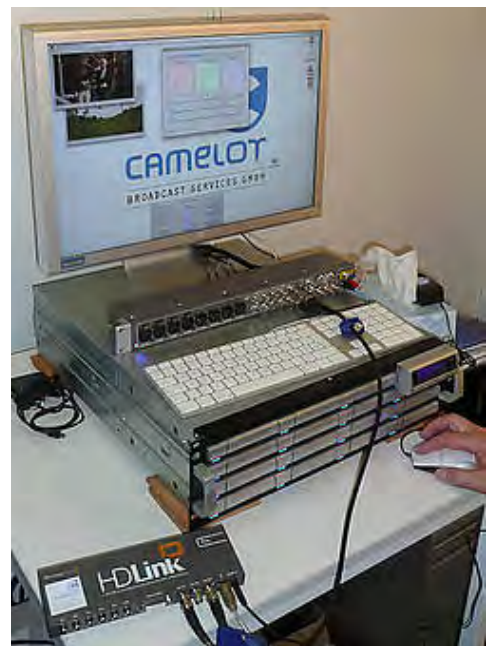
Mit der HD-Link-Hardware von Blackmagic will Camelot seine Monitor-Cases bestücken und LUT-fähig machen.
